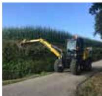
Une épareuse est une machine qui coupe ou broie les buissons et l'herbe au bord des routes et autoroutes, ou diverses voies de circulation. On
