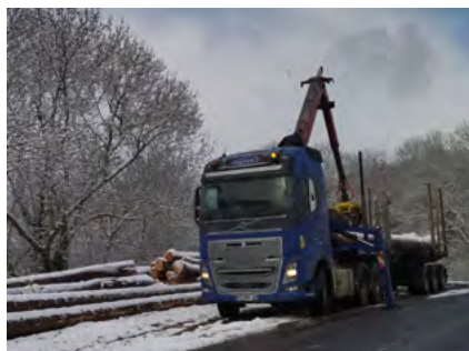
Grumière en place pour le chargement
